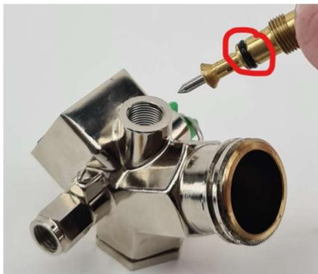
3. Zkontrolujte polohu o-kroužku na obrázku výše a v případě potřeby jej vyměňte.
