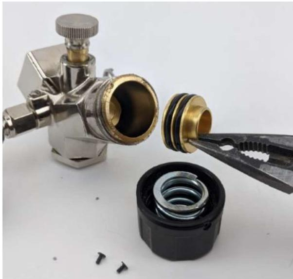
**Krok 4.** Pomocí sady nástrčných klíčů 16 mm nebo 5/8" demontujte. Ujistěte se, že jste demontovali i spolu se sítkem (mosazná část s černým o-kroužkem). Pokud O-kroužek nevyskočí současně, můžete ho vytáhnout samostatně pomocí špičatého předmětu:
