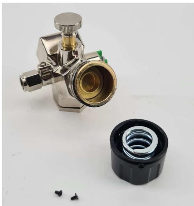
**Krok 3.** Pomocí sady jehlových kleští odstraňte membránu pístu:
