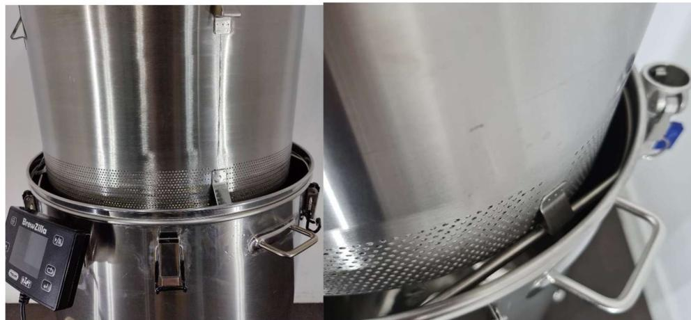
Jakmile scezovací koš zavěšen nad kotlem (viz obrázek), nalijte teplou vodu (přibližně 75-80 °C) na horní síto uvnitř koše, aby se slad opláchl od většiny zbývajících cukrů.
