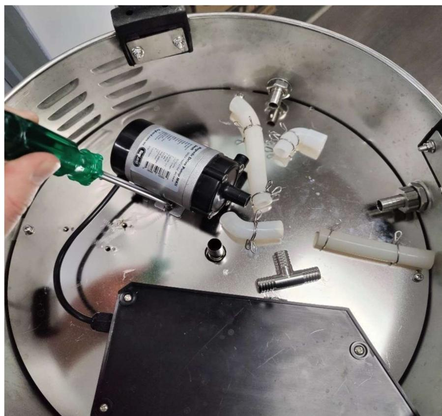
Potom zapojte hadice (viz obrázek) tak, aby T-kus rozdělil výstup kotle ke kohoutku dříve, než dosáhne vstupu čerpadla.
