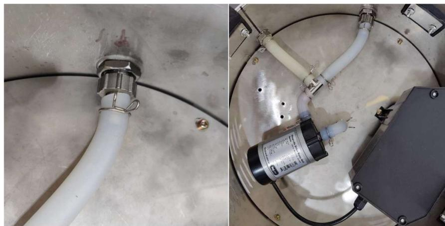
Hadice na spodní straně BrewZilly Gen 4.0 lze upravit tak, aby bylo možné vypustit tekutinu bez průchodu čerpadlem (lze využít k vypuštění kotle přes kohoutek, když je čerpadlo ucpané). Pro přepojení musíte posunout čerpadlo (viz obrázek).
